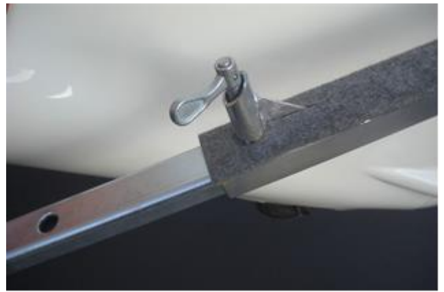
... den Federriegel lösen, die Stange etwas ausziehen, aber den Federriegel nach vorne, stehen lassen.
