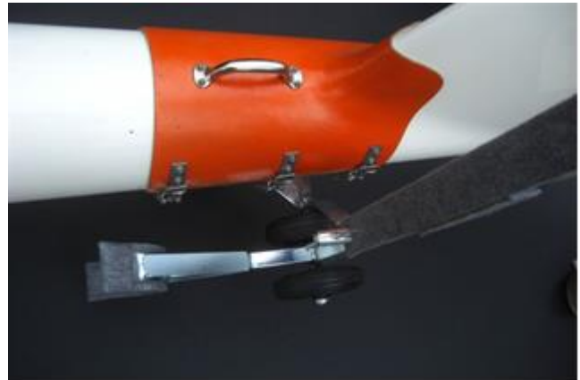
...und die Schlepstange senkrecht in das Querrohr des Kullers Einstecken.
